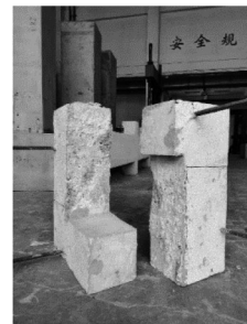
b 试件直剪破坏
