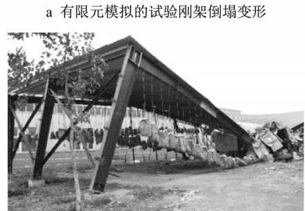
a 有限元模拟的试验刚架倒塌变形 b 试验刚架倒塌实际变形图 [6] 图3 试验刚架倒塌模式对比 Fig.3 Comparison of collapse mode of the test frame
