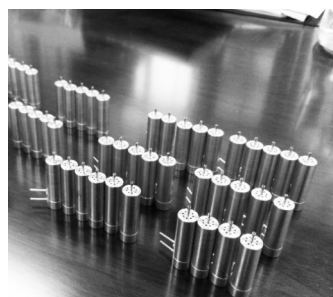
图4 行人风环境测量中的改进欧文风速探头
