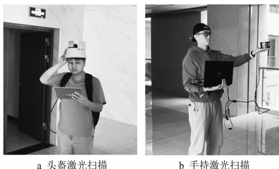
图 6 头盔及手持激光作业示意图
