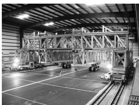
图 6 门架式加载设备
