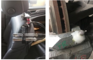
图1 驾驶员耳旁传声器与卡钳振动加速度计布置
