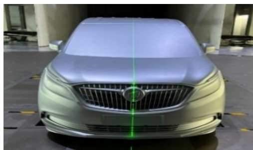
图3 泛亚缩比风洞缩比模型测试 Fig.3 Test in PATAc RSWT
