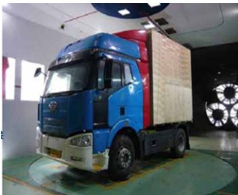
图1 重卡实车+简化货箱绵阳风洞试验现场
