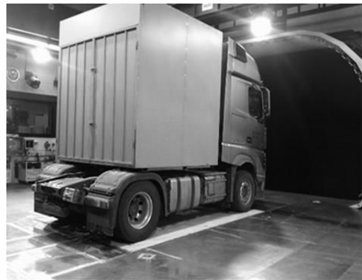
图2 重卡实车+简化货箱奔驰风洞试验现场
