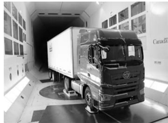
图3 重卡+28英尺货箱工况NRC风洞试验现场
