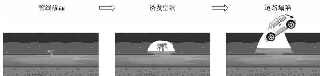
图1 管道渗漏诱发路面塌陷示意
