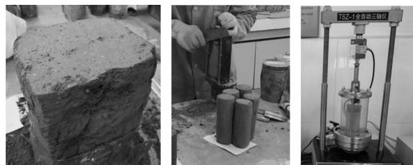
图1 土样制备及三轴试验
