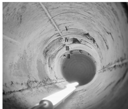
图8 开挖完成后洞室的破坏情况
