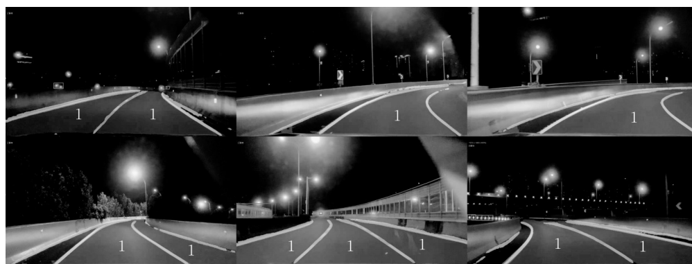
图6 可行驶区域分割与车道线识别实际检测效果
