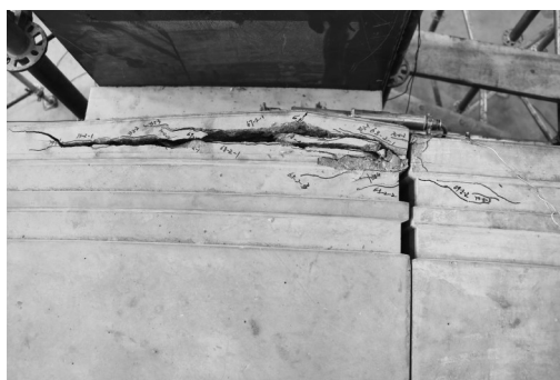
图10 单环管片衬砌结构主要破坏现象
