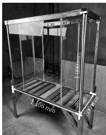
图5 模型试验箱(单位: mm)
