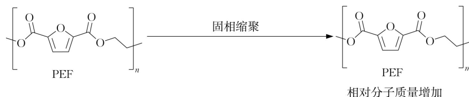
图 3 固相缩聚法制备 PEF 聚酯
