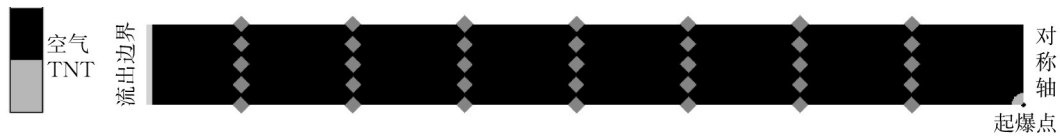
图 2 半球形 TNT 扁平大空间内爆炸二维轴对称矩形模型
