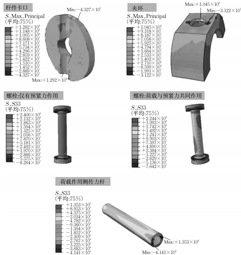
图 4 夹环构件的空间应力分布特征 Fig.4 Spatial stress distribution characteristics of clamping ring
