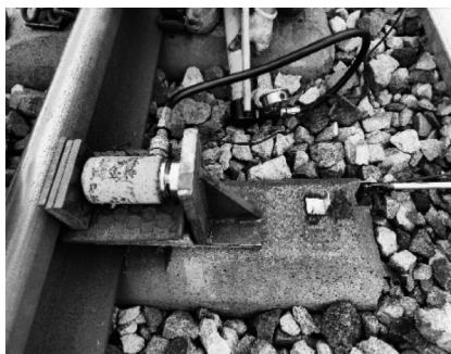
a 现场作业后道床横向阻力测试
