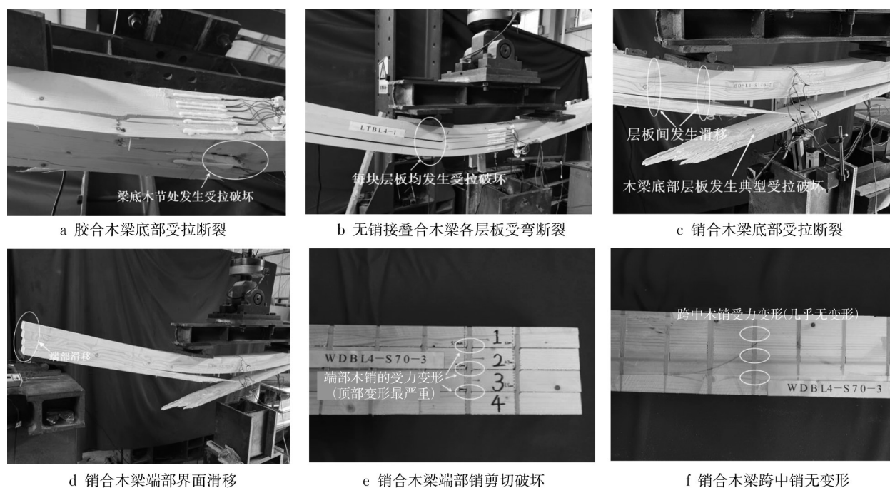
图9 试件主要破坏模式
