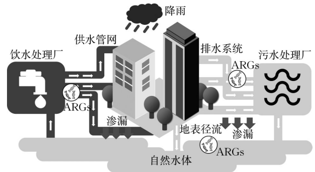
图1 ARGs随水体在城市中的循环途径
