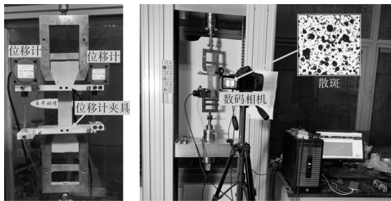
图 2 单轴拉伸装置
