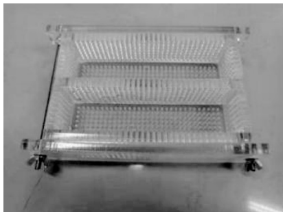
图1 设计的试模(40 mm×40 mm×160 mm)
