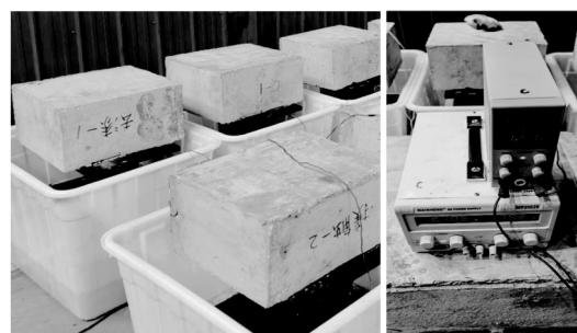
图4 氯盐侵蚀试验装置照片
