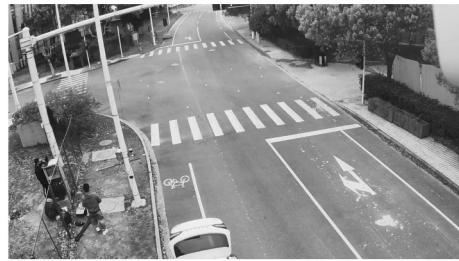
b Pandar 64激光雷达-元戎相机标定物摆放位置
