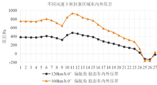
图5 密封条不同位置处的内外压差(0°偏航角)
