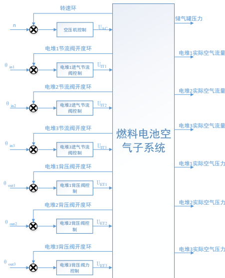
图 3 多堆燃料电池空气控制系统结构示意图
