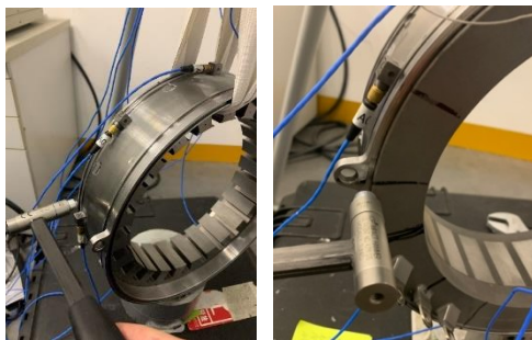
(a) 定子铁芯+水套实验 (b) 定子系统+水套实验
