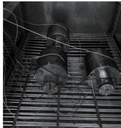
图 5 对流烘箱中的 EP 阀测试样品及电路结构
