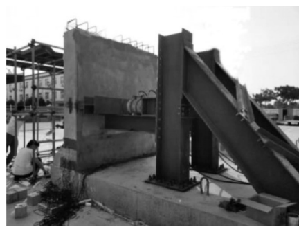
图7 挡土墙试验加载装置
