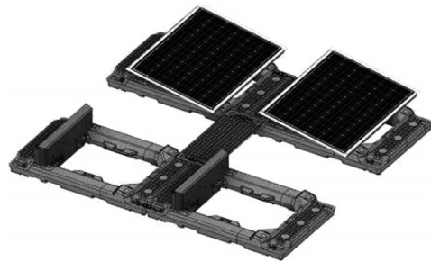
图3 三井建设(SMCC)设计的浮动平台 [7]
