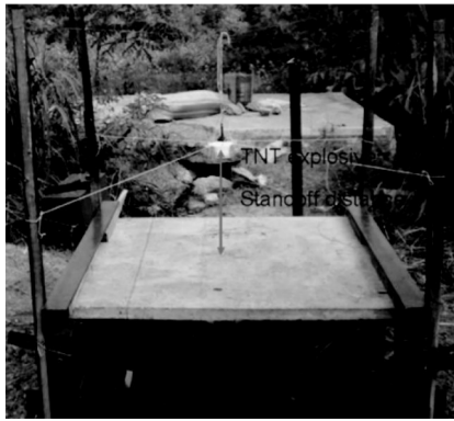
图10 RC板抗爆试验 [18]
