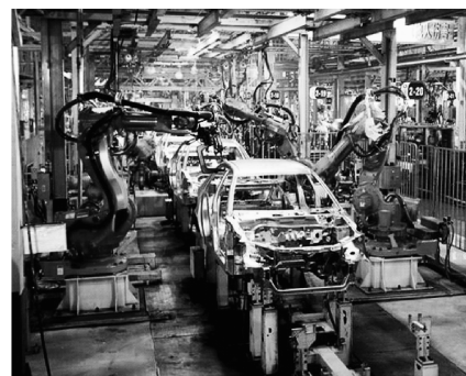
图 1 白车身制造多机器人拼焊工位
