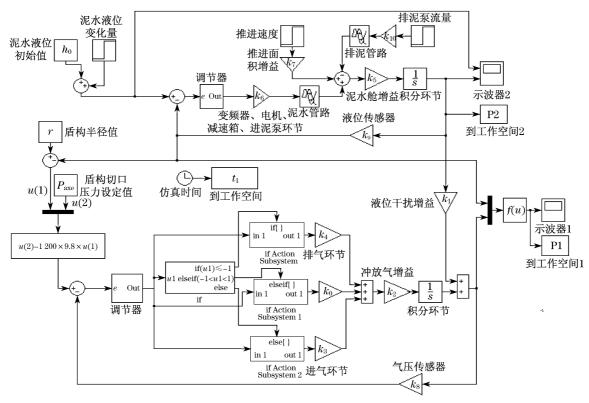
图 2 泥水平衡盾构开挖面平衡控制系统数学模型
