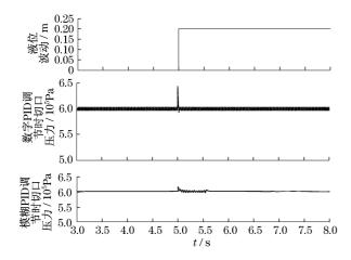
图 5 系统参数变化时的输出响应 Fig. 5 Output response following the change of system parameters
