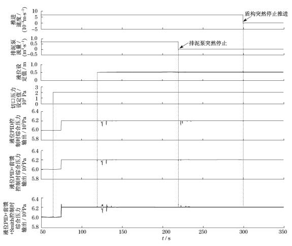
图 6 跟随输入阶跃变化和存在阶跃扰动时的输出响应
