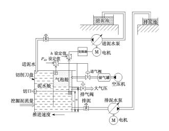
图 1 泥水平衡盾构开挖面平衡系统 Fig. 1 Balance system of excavating face for slurry shield
