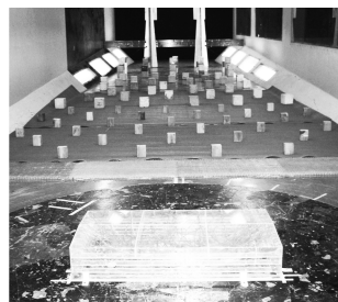
图7 风洞试验中的刚体模型
