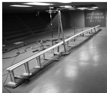
图 2 某超大跨径斜拉桥全桥气弹模型
