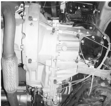
图 2 变速器箱体运行工况下加速度测量
