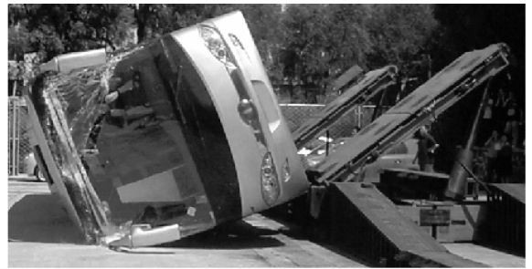
图 9 客车实车侧翻试验
