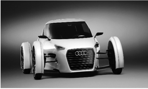
图 5 典型的分体式车身造型:奥迪 Urban 概念车 Fig.5 A typical split-body styling: Audi Urban Concept
