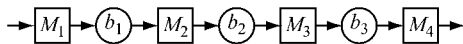
图 2 拥有 4 台设备和 3 个缓冲区的伯努利生产线 Fig. 2 Bernoulli serial production line with 4 machines and 3 buffers
