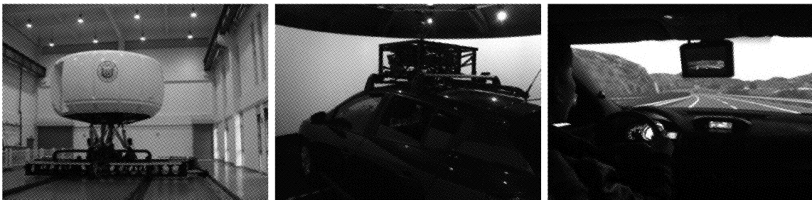
图 1 同济大学高仿真驾驶模拟器
