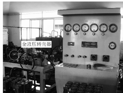
图 5 全液压转向器试验现场
