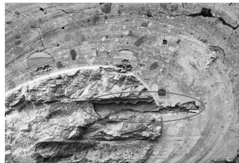
图9 XJ2模型胶接缝脱空现象
