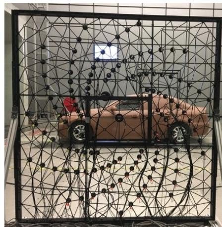
图 20 整车气动声学风洞内 DrivAer 油泥模型测试
