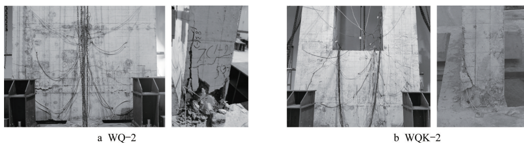
图9 低周反复加载下试件破坏模式
