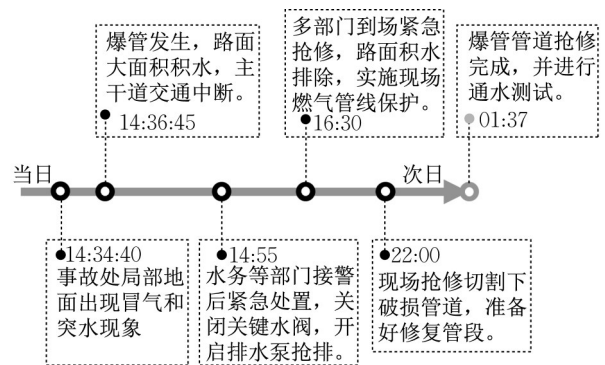
图1 本次供水管道爆管事件时间节点
