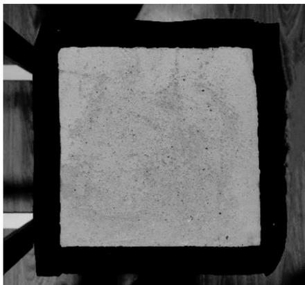
图2 混凝土试件周围包裹保温材料实物图
