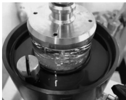
图5 t=40 \text{ h} 时1号土样流出的煤油
