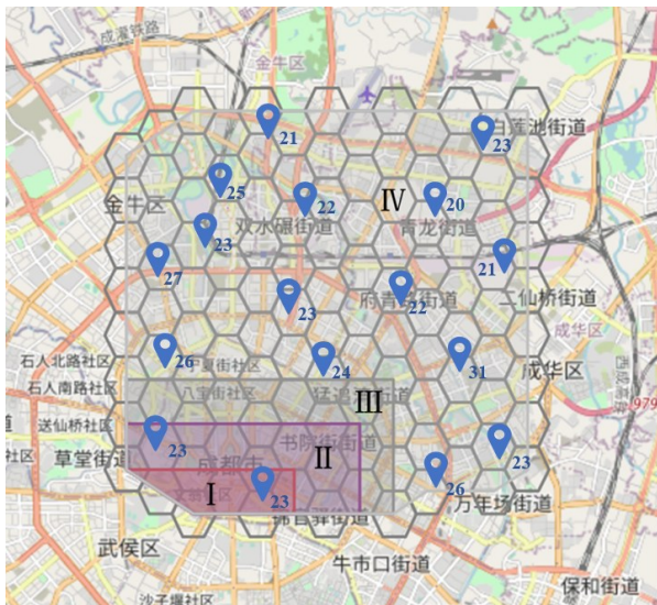
图 10 基于 PSO 算法的充电站选址定容方案
